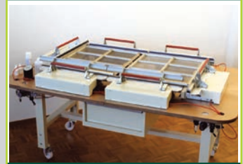
İpek Gerdirme Cihazı Silk Stretching Machine аппарат для натяжки сита آلة تمتد الحرير
